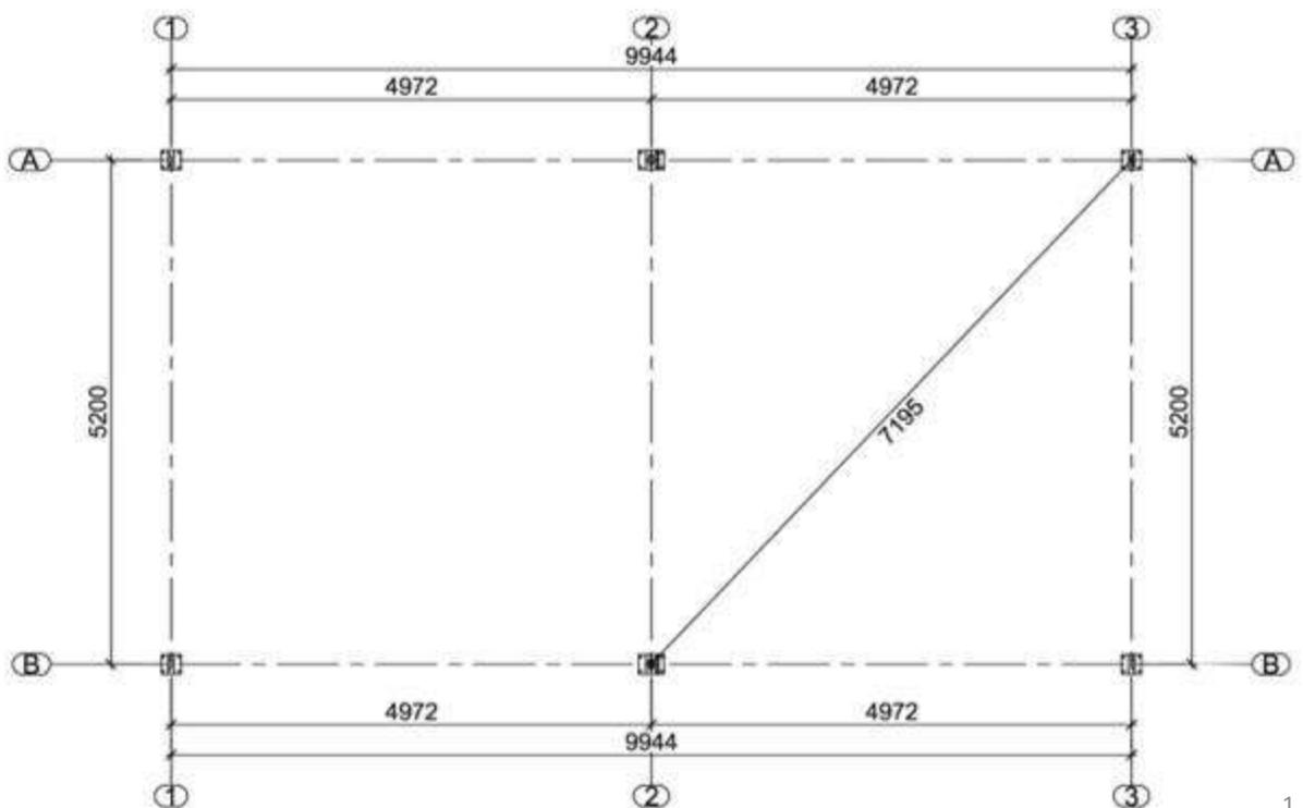
1. Assemblez les poteaux et les fermes avec les platines GP et mettez les cornières pour la fixation des pannes et des contreventements.
