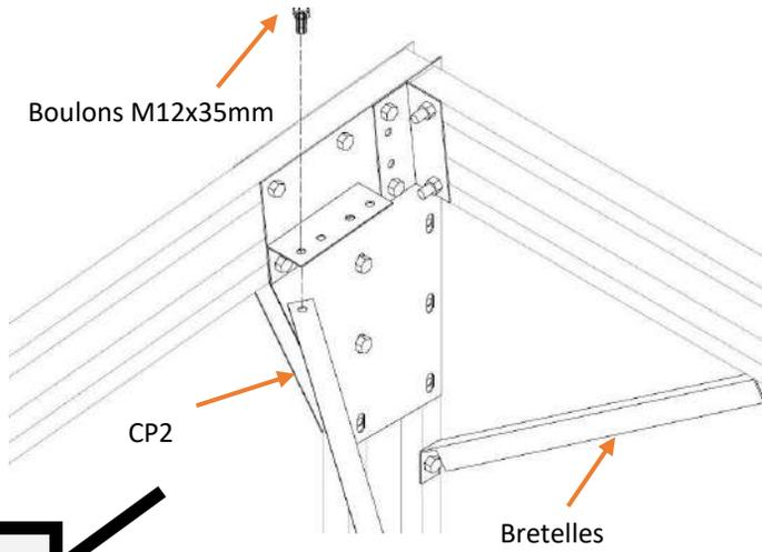
Percez les trous dans les profils pour fixer les bretelles avec les boulons M12x35mm
